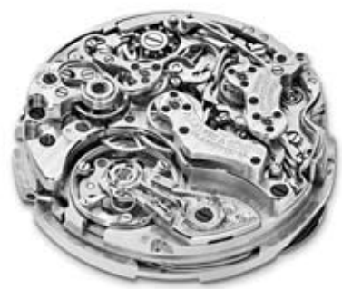
Das Uhrwerk des DATOGRAPH PERPETUAL. 556 Einzelteile stimmen die Lange'schen Meister perfekt aufeinander ab, damit sie den Takt der stetig fließenden Zeit präzise wiedergeben.
